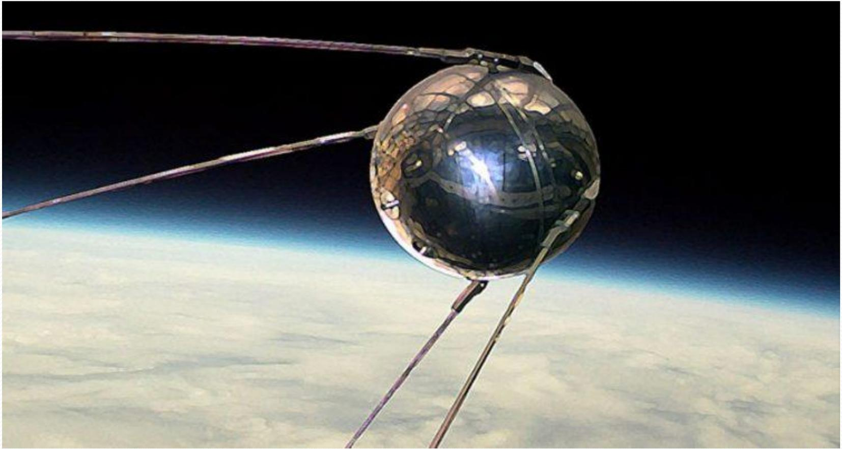
Устройство представляло собой две сваренные полусферы из магниевого сплава и четыре стабилизатора, параллельно играющие роль передающих антенн. Общая масса устройства не превышала 88.5 кг.
